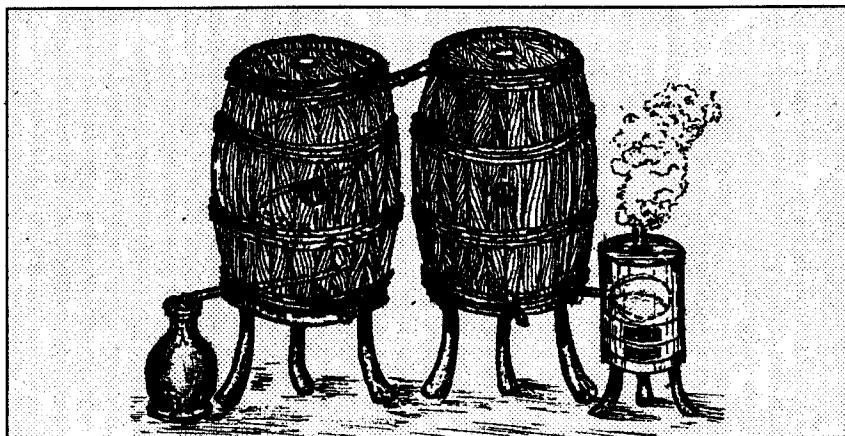
Рис. 26. Перегонный аппарат XVII века из дерева, с вынесенной печкой [52].
