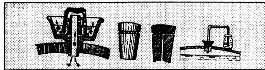
Рис. 13. Конструкции бродильных шпунтов. Стрелками указано направление движения углекислого газа [8, 10].
