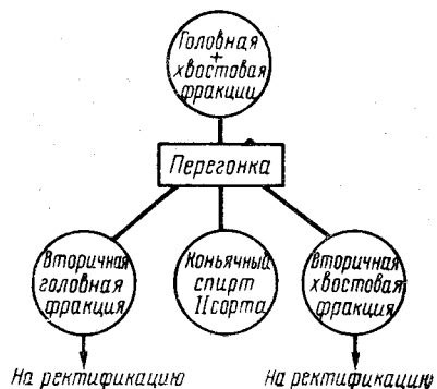
Рис. 11. Схема перегонки смеси головной и хвостовой фракций.
