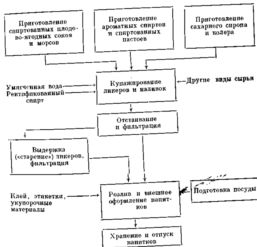
ПРИНЦИПИАЛЬНАЯ ТЕХНОЛОГИЧЕСКАЯ СХЕМА ПРОИЗВОДСТВА ЛИКЕРОВ И НАЛИВОК
